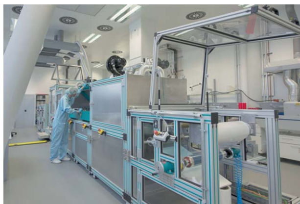
Rolle-zu-Rolle Herstellung von elektrochromen Folien unter Reinraumbedingungen im Fraunhofer ISC Würzburg (© K. Selsam, Fraunhofer ISC).
