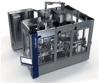
Der Craftmate G ist ein kompakter Bierfüller und verarbeitet bis zu 24000 Glasflaschen pro Stunde. (Fotocredit: Markus Vogel, Krones AG)
