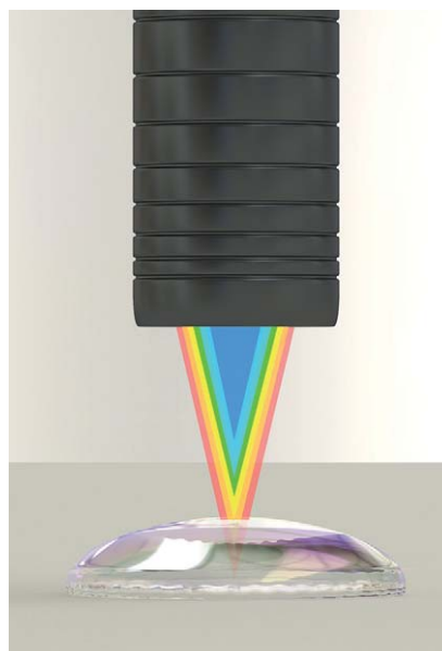
Abb. 4 Das konfokal-chromatische Messsystem, bestehend aus dem Sensor confocalDT IFS2405-3 und dem Controller confocalDT IFC2461, prüft die Mittendicke von dünnen optischen Linsen sowie deren Kontur beziehungsweise Krümmung. Im Zentrum der jeweiligen, diffus-reflektierenden Linse wird die Dicke mit einer Auflösung von 36 nm erfasst.
