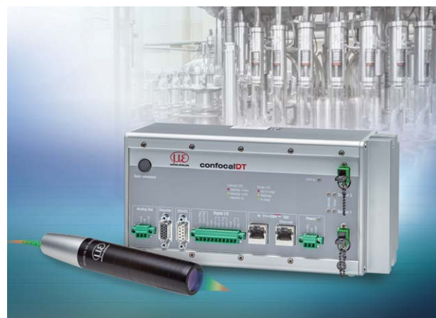
Abb. 1 Konfokal-chromatische Sensoren liefern „glasklare“ Messwerte.
