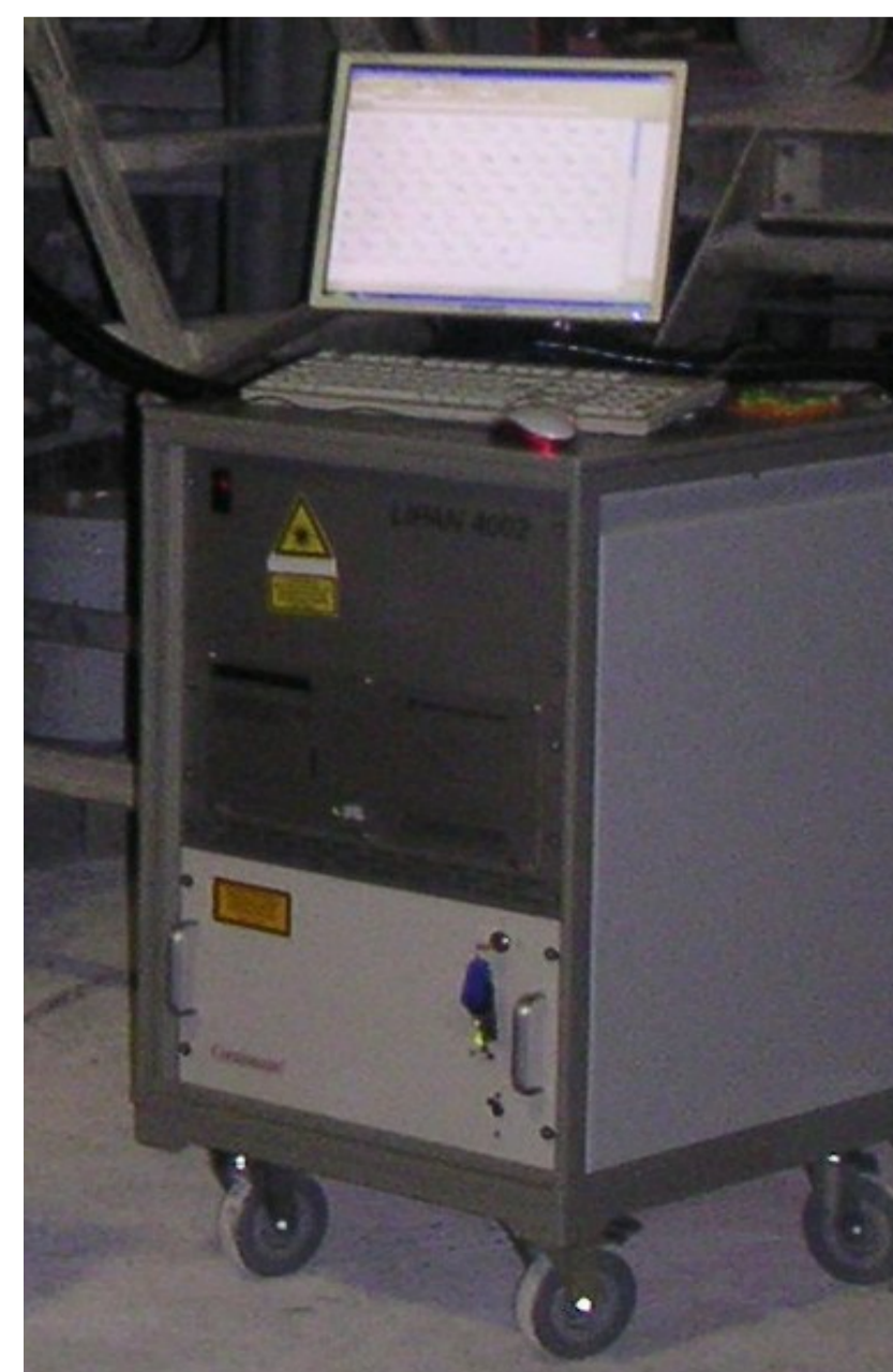
Bild 2 und 3: Mobiles LIBS-Messgerät der HVG zur Messung in Schmelzaggregaten, angepasst an die Betriebsbedingungen der Glasindustrie.
