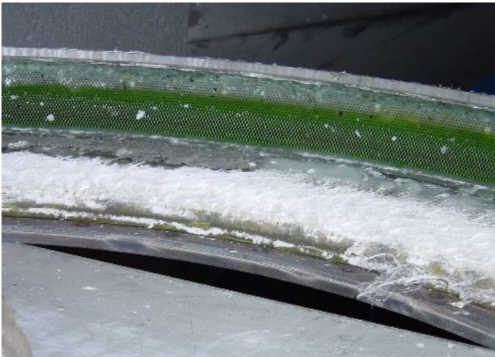
Bild 2: Schleuderring nach Lebenszyklus, wenig Rückstände (weiße Partikel).
