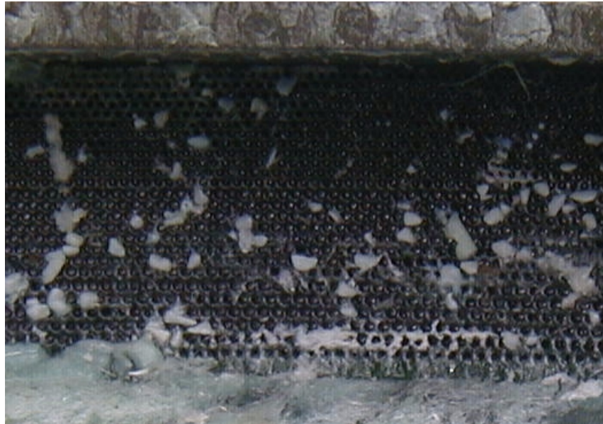
Bild 3: Ausschnitt eines Schleuderringes, verunreinigt mit Glaskeramik.
