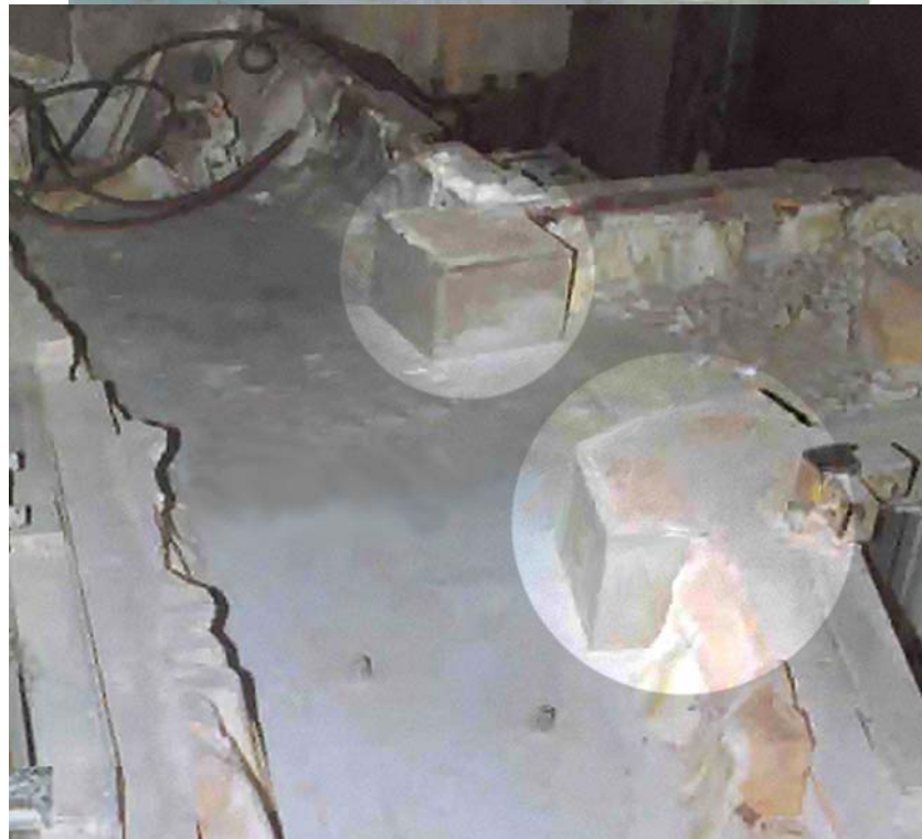
Bild 3: Platinbeschichtete Durchlassecksteine nach 20 Monaten Einsatz in einer Opalglasschmelze.
