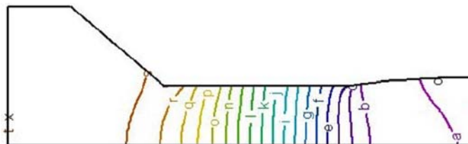
Bild 7: Druckverteilung in einer Düse (um 90^\circ gedreht).
