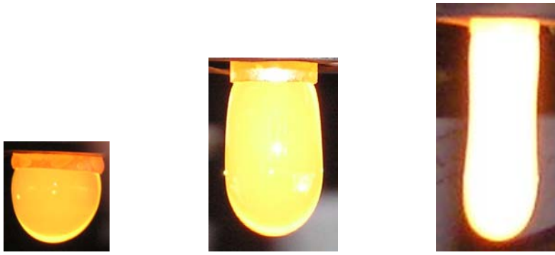
Bild 1a-1c: Tropfenformen vor dem Schnitt.
