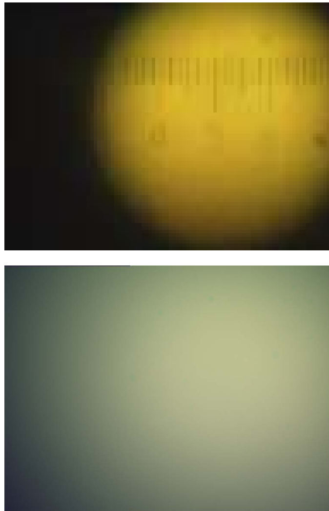
Bild 6: Visuelle Beurteilung der Farbplättchen im Durchlicht, oben: GK1, unten: GK2.
