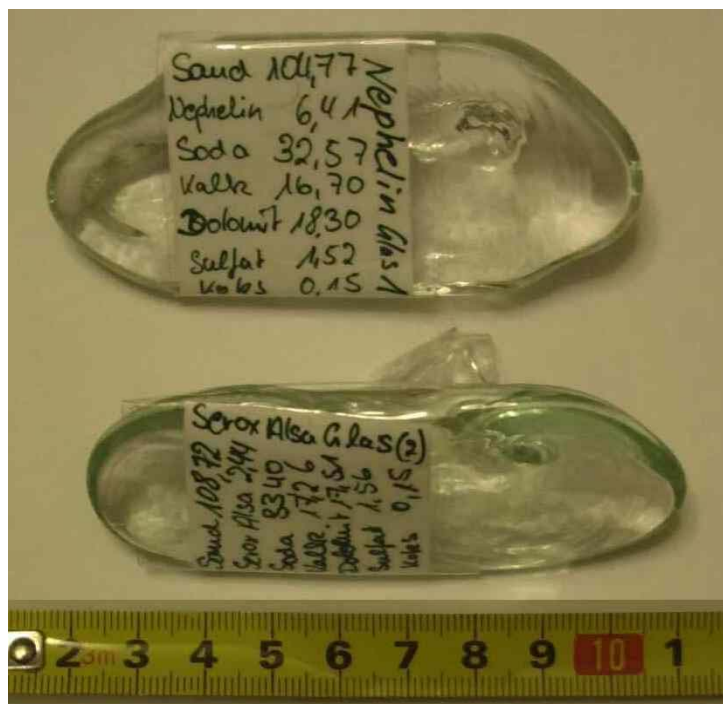
Bild 3: Schmelzproben von Behälterglas mit Nephelin (oben) und SEROX (unten)
