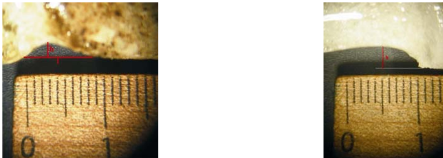
Abb. 1: Charakterisierung des Korrosionsausmaßes für Schamotte (links) und Zirkonsilikat bzw. Korund-Zirkon (rechts).
