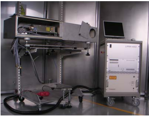
Bild 8: LIBS mit „großer Optik“ für Messungen im Bereich von 2,5 - 12 m Brennweite.
