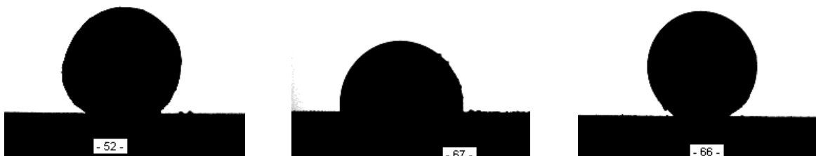
Bild 1: Erhitzungsmikroskopische Aufnahmen zur Bestimmung des Benetzungsverhaltens auf mit Schmiermitteln behandeltem Grauguss
