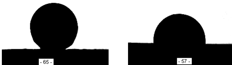
Bild 3: Erhitzungsmikroskopische Aufnahmen zur Bestimmung des Benetzungsverhaltens auf mit Vorformlacken behandeltem Grauguss
