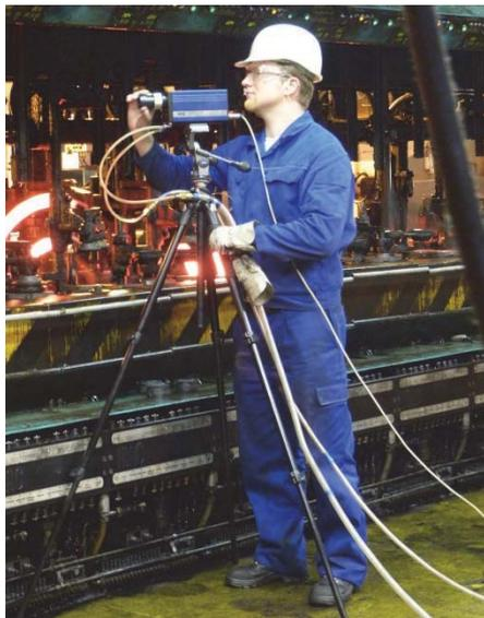
Die am häufigsten eingesetzte Messtechnik im Prozess der Glasherstellung ist die Temperaturbestimmung.
